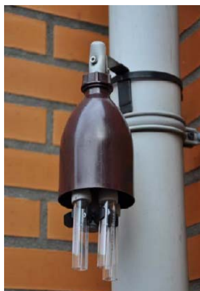
Figuur S1.1 Drie Palmesbuisjes in een houder.
